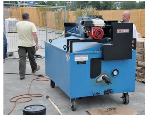
De warme kleefstof wordt ‘au bain-marie’ op temperatuur gebracht.
